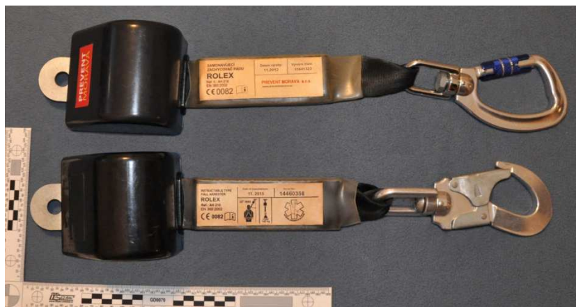
Obr. 3: Zatahovací zachycovače pádu Prevent Morava Rolex (rv: 2012), Lezectví.cz Rolex (rv: 2015)
