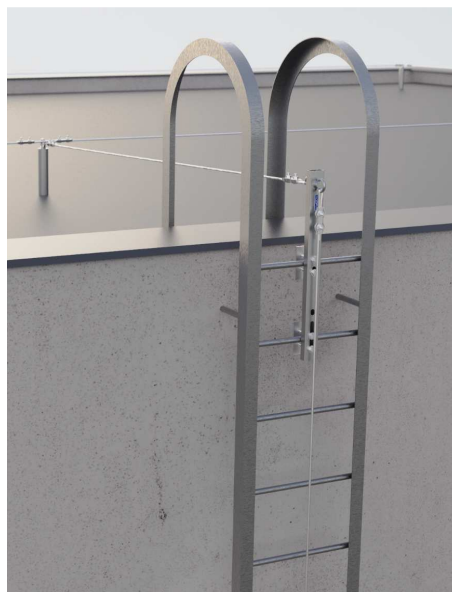
Obr. 15: Příklad zajištění žebříku dodatečně instalovaných pevným vedením [28]
