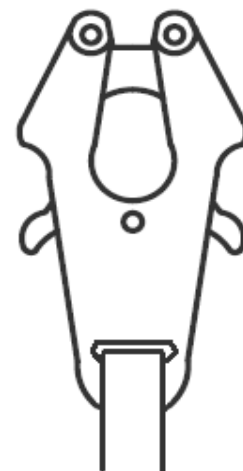
Obrázek 2 - Karabina typu A (přestože je na konci textilní popruhovú smyčky, nejedná se o karabinu typu T)
