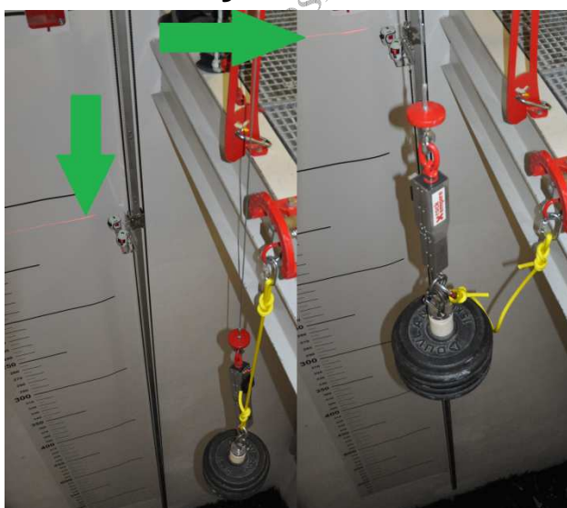
Obr. 5: Vyměřování zkušebních vzorků. Zelené šipky na obrázku ukazují laserové vytyčení výšky
