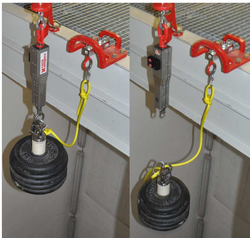
Obr. 8: Průběh jedné ze zkoušek s dračí smyčkou
