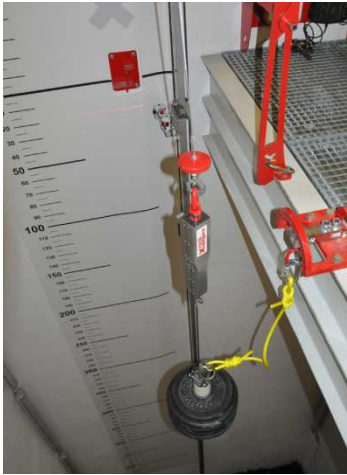
Obr. 6: Padající zkušební břemeno při zkoušce osmičkového oka
