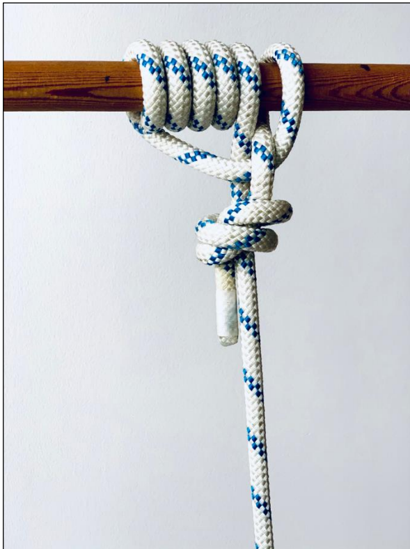
Obrázek 3 Linhartova beznapěťová smyčka – levá varianta
